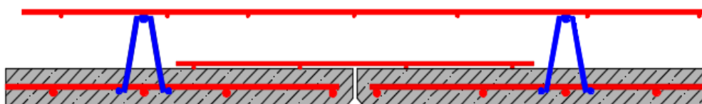
A2015-PD-30 : Préparation avant bétonnage
